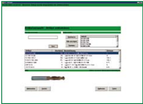
Die Werkzeugauswahl erfolgt nach unterschiedlichen Kriterien, z. B. Artikelnummer, Bezeichnung oder Größe.
