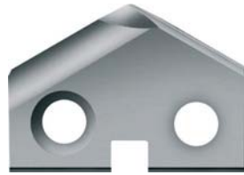
NC-Platte (HSS-E/PM HSS-E oder HM) mit 90° oder 120°. (Je nach Ø wird der 90°-Winkel im Spitzenbereich verzerrt)
