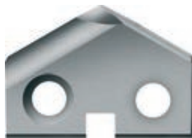
Пластина для центрования отверстий (HSS-E/PM, HSS-E или твердый сплав) с 90 или 120 градусами (в зависимости от диаметра угол в плане 90 гр. может быть изменен)
